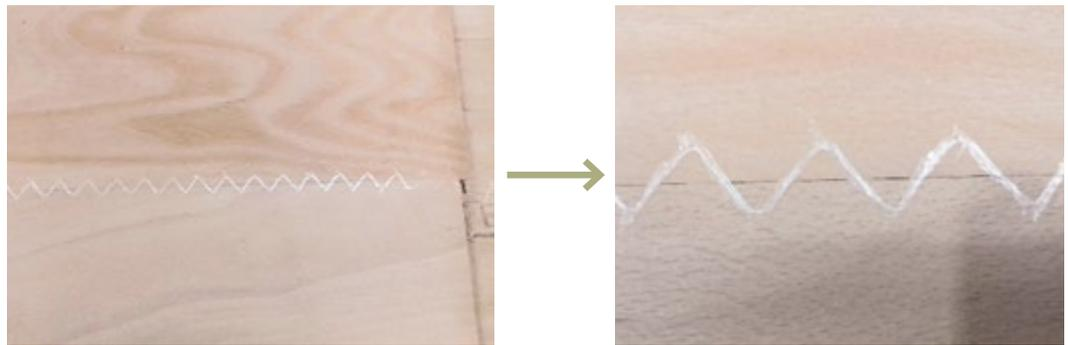
➤ **Machine de réparation pour corriger les défauts du placage**
